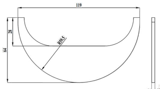
Переходник высот, между лотками высотой 80(97)мм и 120(135)мм.
